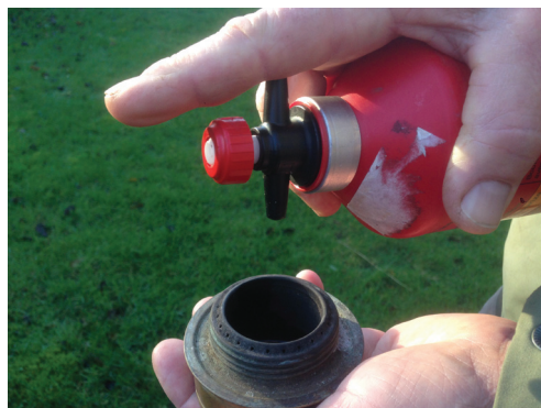
Når man slipper den 'røde knap' lukkes der for spritten. Ved transport skrues den 'røde knap' ned, så der ikke kan løbe sprit ud.
